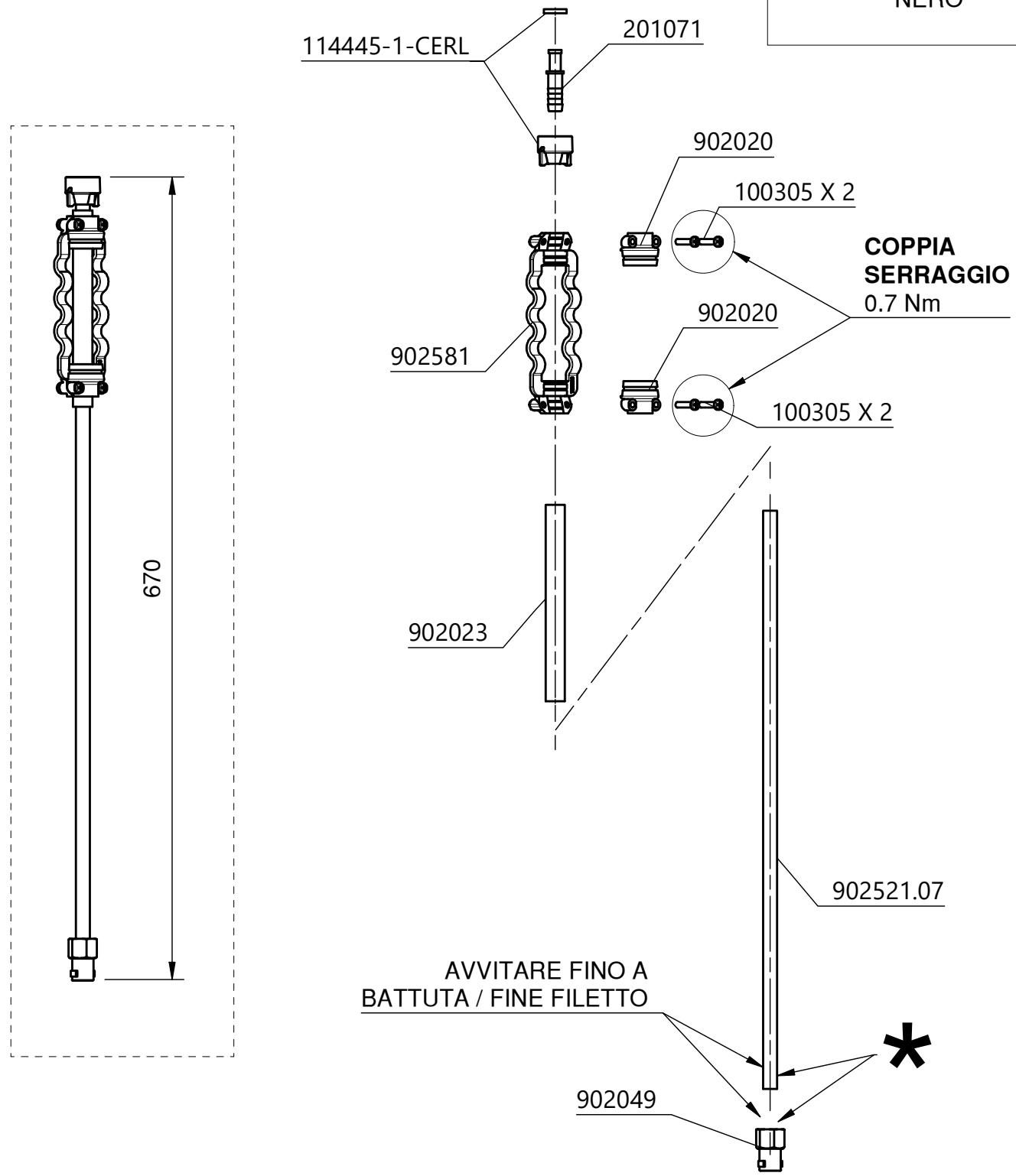
**NB** PER L'ASSEMBLAGGIO UTILIZZARE MASCHERA VERDE
