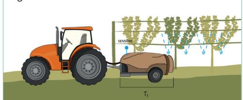
Posizionando il potenziometro "T1" al minimo, i sensori ultrasuoni sono disabilitati e il box funziona in modalità manuale.
