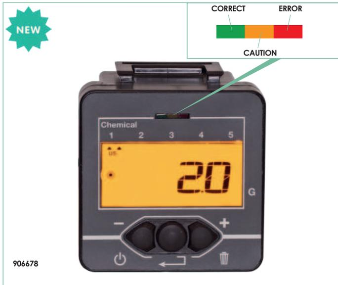
**Monitor con sistema modulare MSB.** Pensato per agevolare gli operatori nella preparazione delle miscele di prodotti liquidi. Collegato ad un flussometro e ad una valvola per riempimento serbatoio; permette di impostare le quantità target di max 5 prodotti diversi. Al via dell'operatore, parte il riempimento, fermandosi per ogni prodotto alla quantità impostata, e permettendo all'operatore di cambiare serbatoio di prelievo. Il display calcola i galloni erogati per prodotto.
