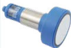
Sensore ad ultrasuoni per rilevazione istantanea bersaglio. Abbinato a Atom 1 permette di rilevare la presenza di vegetazione, attivando o interrompendo l'irrigazione. Distanze limite di lavoro: 600 mm ... 6.000 mm, Tempo di risposta 280 ms, Uscita tensione, Peso 270 g, Cavo compreso
