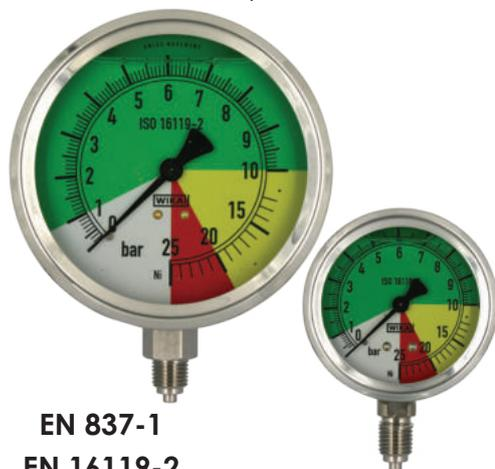
(\*) PAN: Classi di precisione e scale sono rispondenti alle norme ISO 16119-2 2012 sui requisiti ed aspetti ambientali per irroratrici, ed EN837 sull'esecuzione del quadrante di forma concentrica; nella colonna "PAN scala" viene precisato il range di pressioni nel quale la scala di lettura del manometro è conforme a quanto richiesto dal Piano Agricolo Nazionale.
